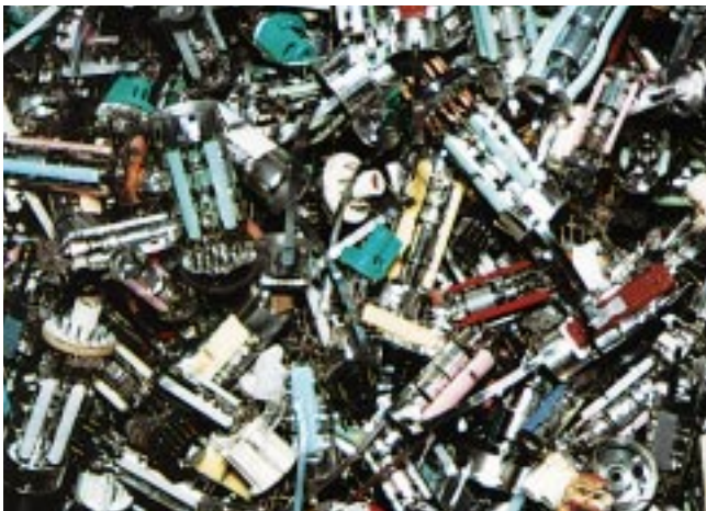
Strahleinheiten nach der Demontage
