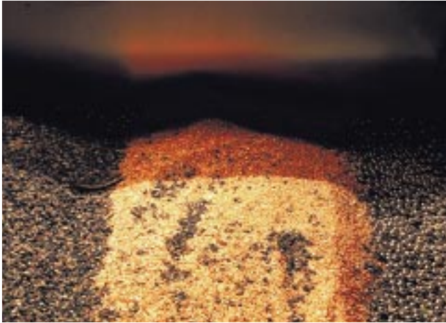
Mechanische Trennung von mehrstufig zerkleinertem Kupfer durch Vibration
