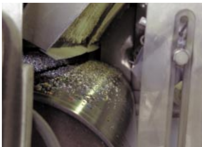
Detail eines Corona Walzenscheiders
