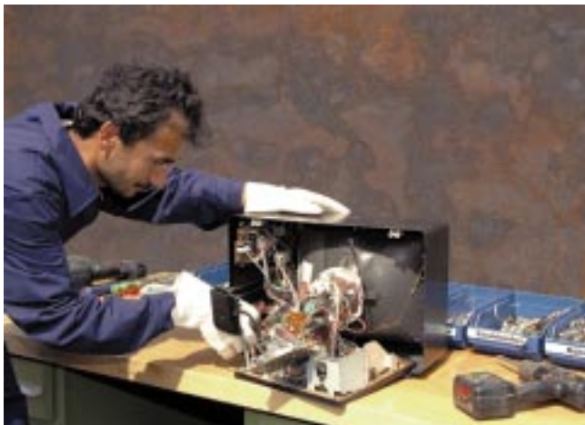
Manuelle Demontage eines Fernsehgerätes
