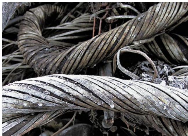
Erdkabel mit Stahlbandarmierung vor der Verarbeitung
